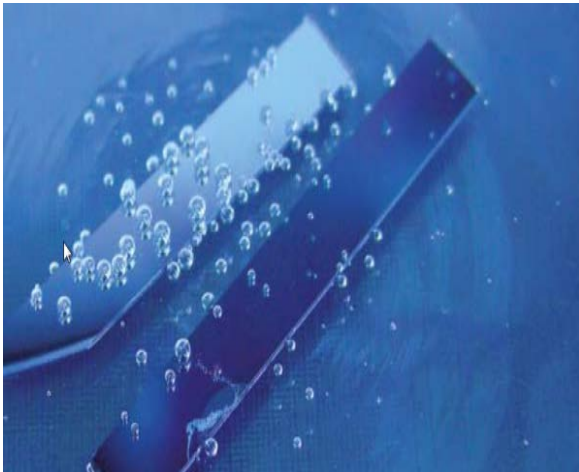
Bild 2: Photokatalytisch aktive Oberfläche unter Wasser zum Abbau von Schadstoffen (Quelle: Fraunhofer IGB).
