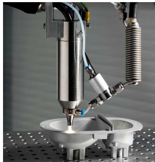
Bild 2: Atmosphärendruck-Plasmadüse zur Schichtabscheidung (Quelle: IFAM, Bremen)
