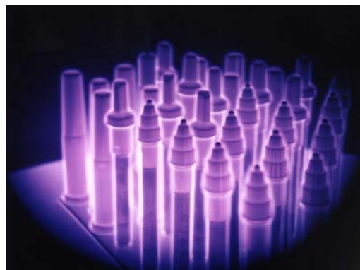
Bild 1: Plasma birgt enorme Potentiale zur Bearbeitung und Veredelung von Oberflächen. Hier: Plasmadiffusionsbehandlung von Werkzeugen. (Quelle: FhG-IST, IOT, Braunschweig)
