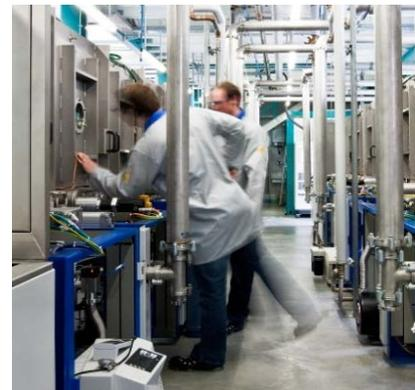
Bild 2: Beschichtungsanlage, in-line verkettet mit Anlage für Fensterschicht (Quelle: [centrotherm photovoltaics AG](#))
