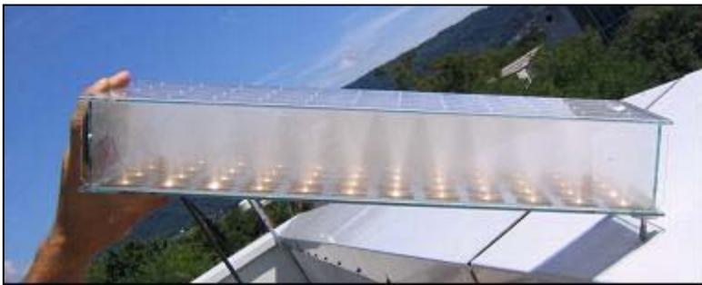
Konzentrator Modul (FLATCON der Fa. Soitec Solar). Der eingeblasene Rauch verdeutlicht den Strahlengang des 500 fach konzentrierten Sonnenlichtes. (Quelle: Fraunhofer ISE)
