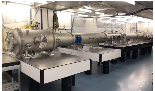
Laboraufbau zur zeitlichen Pulskompression
