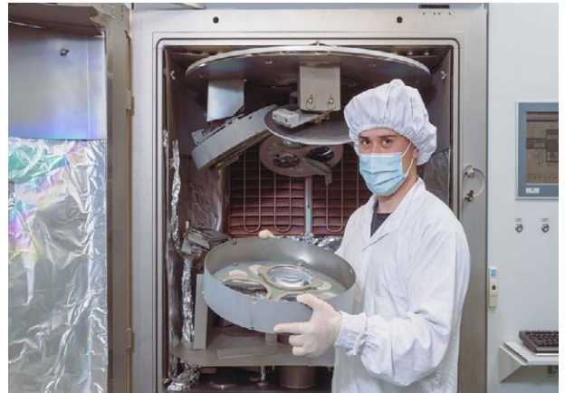
Bestückung einer IAD-Anlage zur Entspiegelung schwach gekrümmter Linsen
