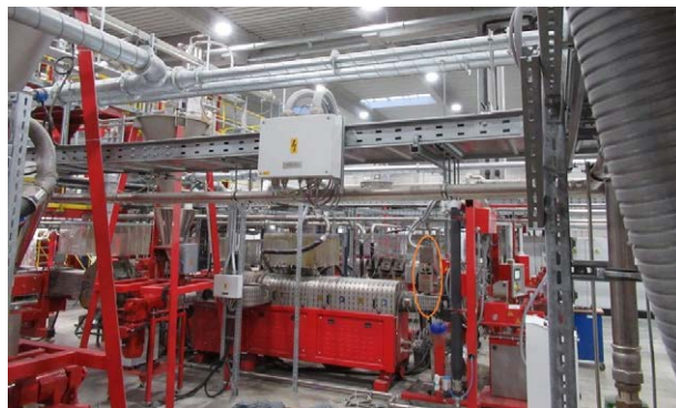
Kunststoffrecycling: Onlinerheometer zur Überwachung rheologischer Eigenschaften.
