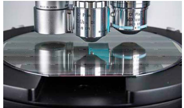
Ausschnitt eines optischen 3D-Oberflächenmessgerätes: Objektive-Messprobe
