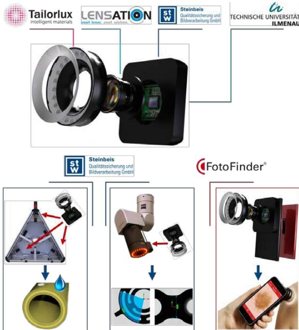
Bild 2: Orts- und multispektral auflösendes Sensorsystem + Anwendungen (Quelle: TU Ilmenau)
