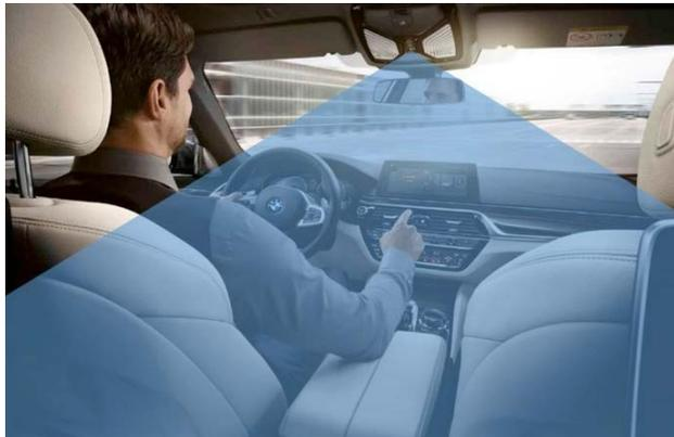
Bild 2: Weitwinkel-Flugzeit-Kamera zur Insassenüberwachung
