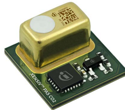
Auf photoakustischer Spektroskopie (PAS) basierender Xensiv CO 2 -Sensor.
