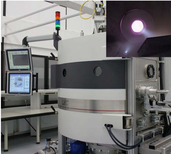
Bild 2: IBS Beschichtungsanlage (Quelle: Cutting Edge Coatings GmbH)
