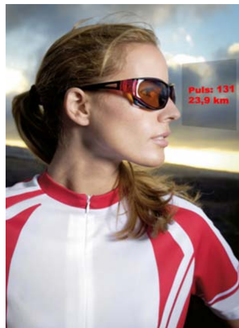
Sportbrille mit optischer Dateneinspiegelung (Quelle: Carls Zeiss AG)
