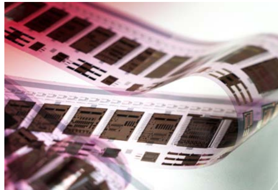
Gedruckte organische Schaltungen von der Rolle für RFID Anwendungen (Quelle: Poly-IC GmbH)
