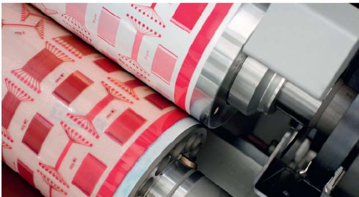
Druckwerk für organische Elektronik an der TU Darmstadt (Quelle: TU Darmstadt)
